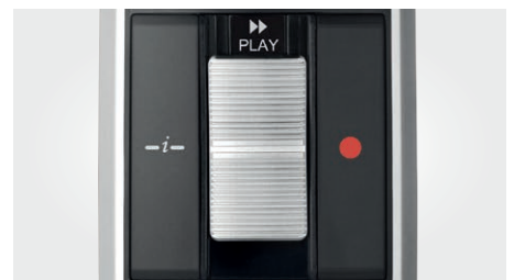
Schuifschakelaar (snel vooruitspoelen, afspelen/opnemen, stoppen, snel terugspoelen)
