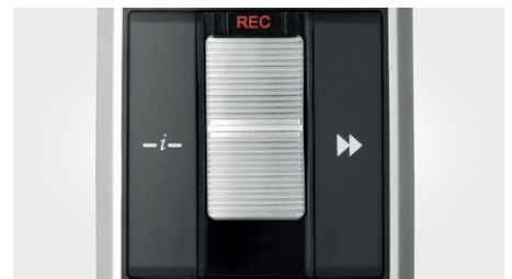
Schuifschakelaar (opnemen, stoppen, afspelen, snel terugspoelen)
